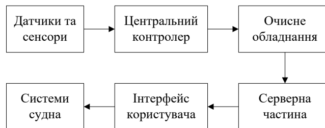
Рис. 1. Схема очищення води на судні
