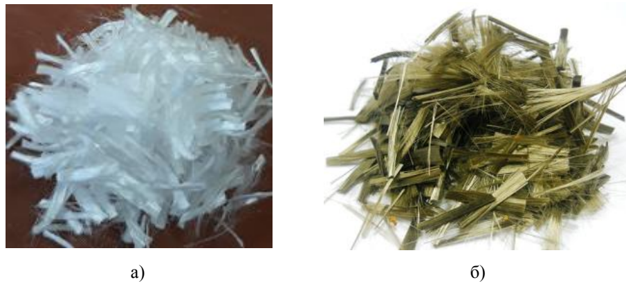
Рис. 1. Зовнішній вигляд поліпропіленової і базальтової фібри (а – поліпропіленова; б – базальтова)
